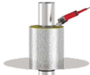
Schritt 2: Kürzung des inneren Rohres mit einer Flex
