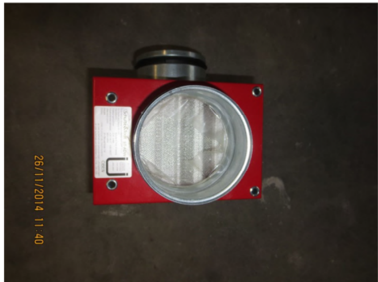
Foto 6: 1. Versuch; Rauschutzgehäuses RSG ST- ADW nach dem Versuch; geschlossene Absperrvorrichtung ST-ADW
